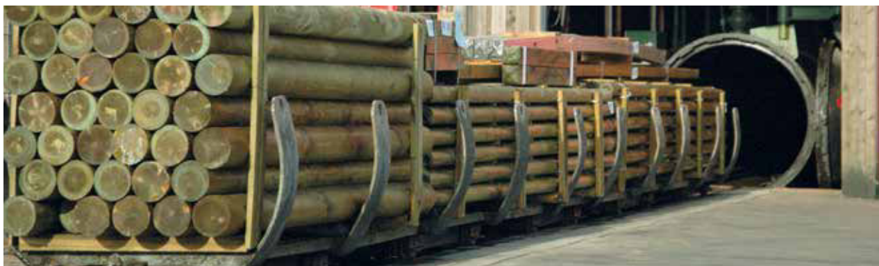
Loren mit Gartenholz – Beladen der Kesseldruckanlage
