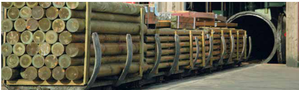
Loren mit Gartenholz – Beladen der Kesseldruckanlage
