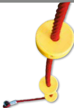
2 Kletterseil verstärkt Ø 16 mm, mit Kunststoffknoten, Abstand 500 mm, Gewindestangen oben für Sattelbalkenbefestigung (ohne Muttern), Ring unten zur Bodenverankerung.
