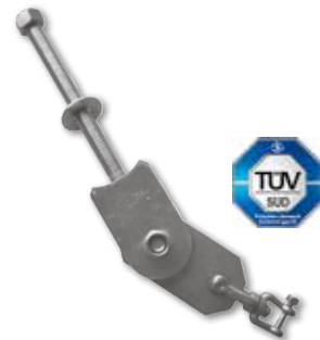
22 Schwinghaken verzinkt, mit Kugellager in einer 10 mm dicken Stahlplatte. Nylonlager (außen Ø 15 mm, innen Ø 6 mm) für die Befestigung von Ketten, Gesamtlänge 160 mm, Gewindestange mit M14-Sicherheitsmutter, Schäkel mitgeliefert.
