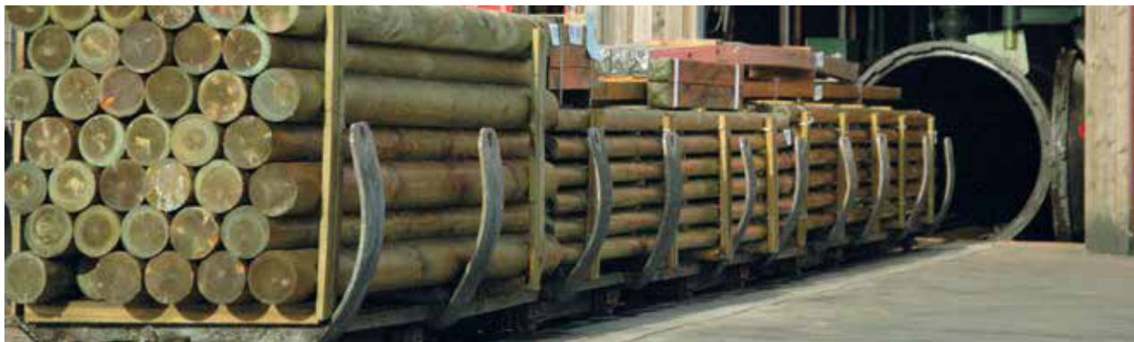
Loren mit Gartenholz – Beladen der Kesseldruckanlage
